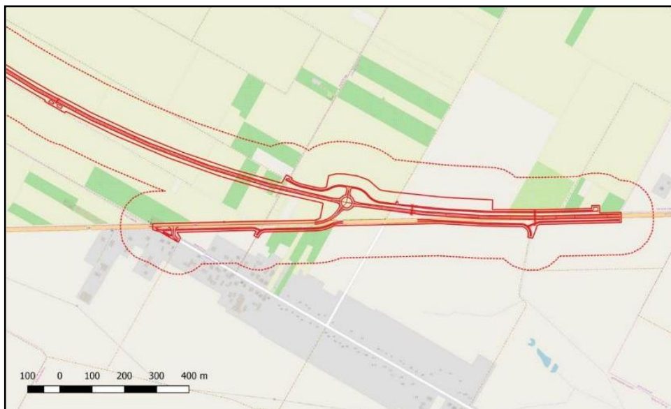
Rys. 2.1. Skrzyżowanie skanalizowane typu rondo (rozwiązanie I)
