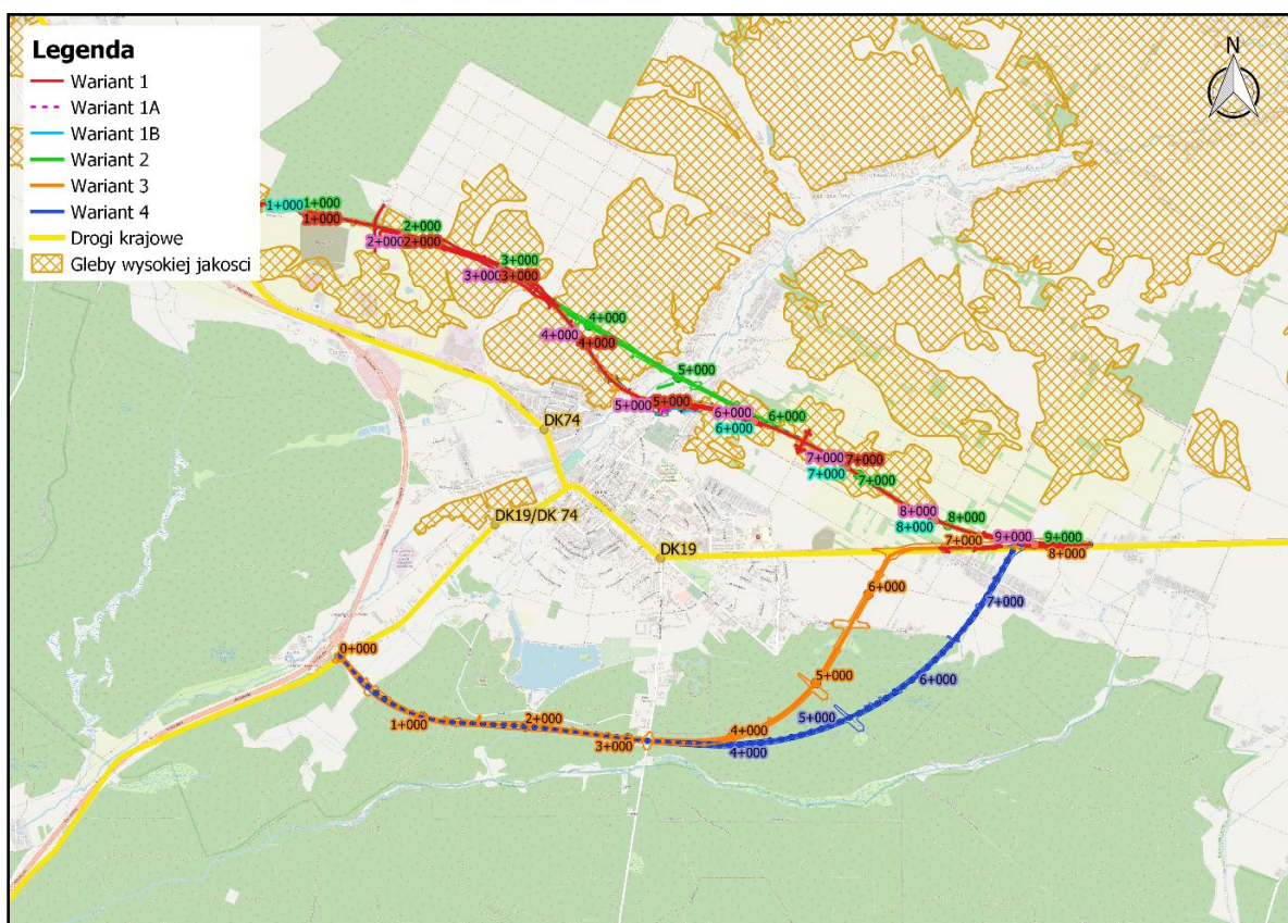
Rys. 7.3 Przebieg analizowanych wariantów na tle położenia gleb wysokiej jakości
