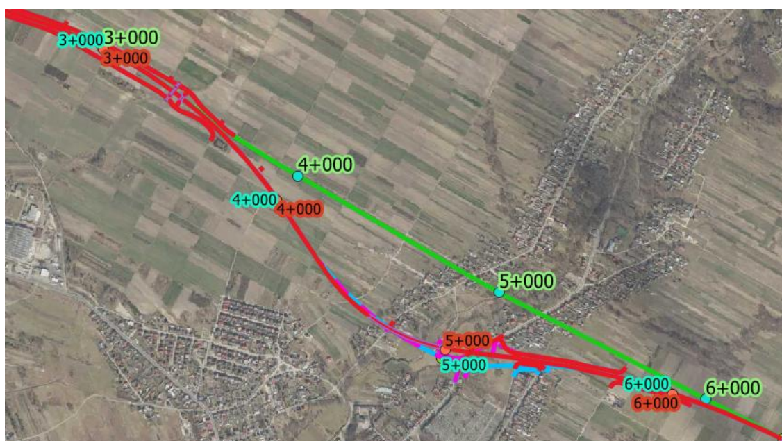
Rys. 5.3 Charakterystyczne różnice w przebiegu wariantów W1 - czerwony, W1A – różowy i W1B – jasno niebieski i W2 - zielony[80]
